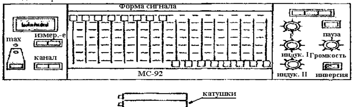
Рис. 2.1 Передня панель магнітостимулятора МС-92М.
